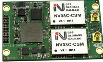
NVS Technologies AG NV08C-RTK-Aカード RTK Positioning Heading+Pitch/Roll
